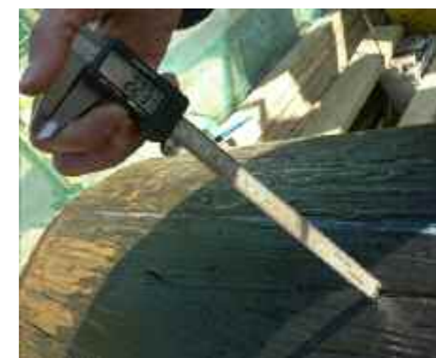
Рисунок 7. Замер глубины царапин на образце № 1.
