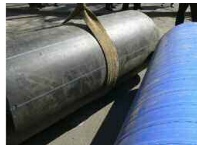
Рисунок 5. Общий вид образцов: № 1 – по ГОСТ 18599-2001 (слева), № 2 – труба ПРОТЕКТ с защитным слоем (справа)
