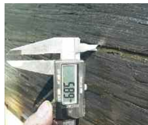
Рисунок 6. Замер ширины царапин на образце № 1.
