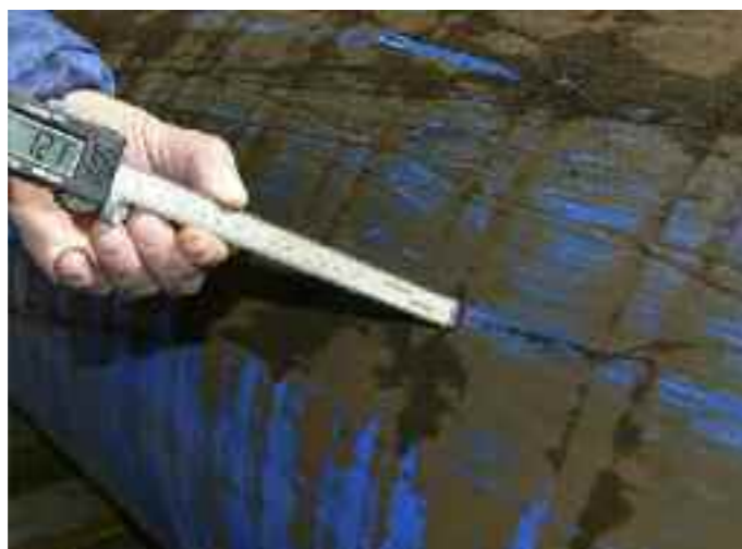
Рисунок 8. Замер глубины царапин на образце № 2.
