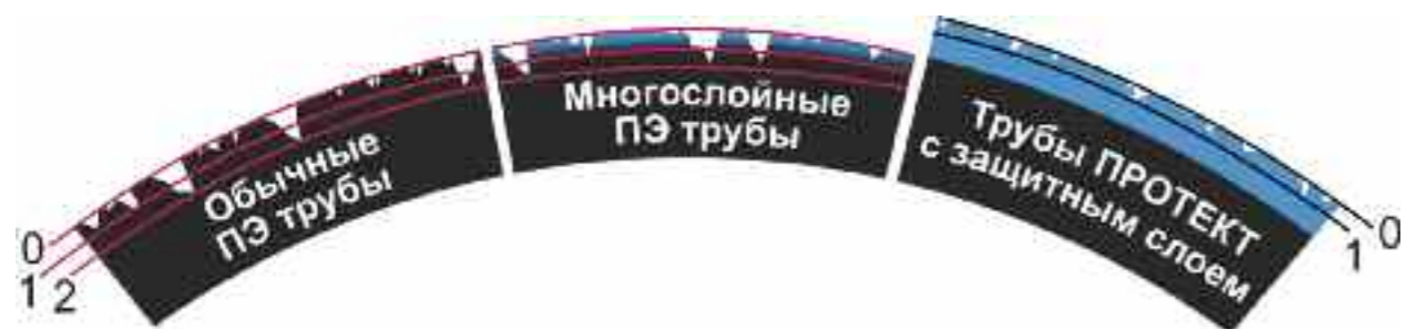
Рисунок 3. Характер механических повреждений различных типов ПЭ труб, возникающих при протяжке бестраншейными методами
