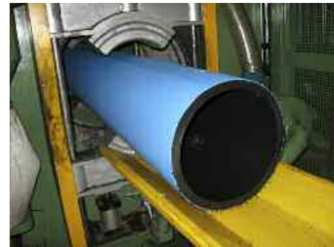
Рисунок 1. Нанесение защитного покрытия методом соэкструзии.
